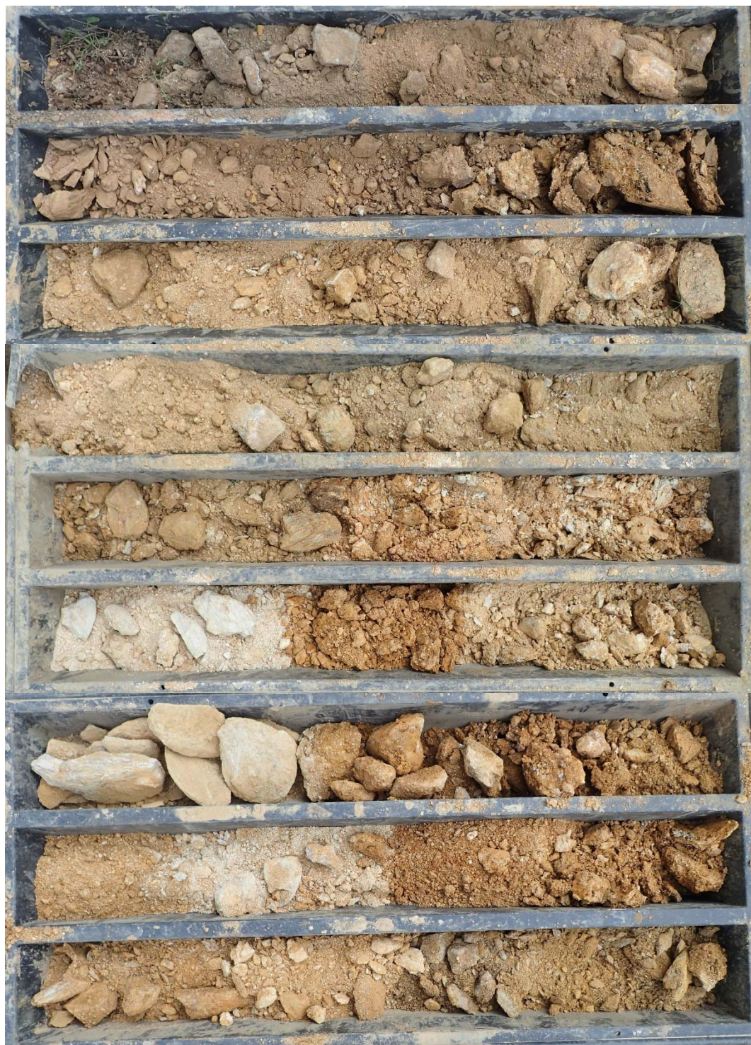
Foto 3: Geologický profil průzkumného vrtu PV-24.906
